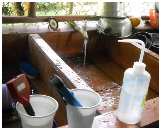
Figura 5. Toma de los parámetros de pH y conductividad en una de las casas (pozos) seleccionadas.
