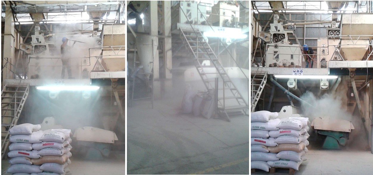
Ilustración A3-6. Limpieza de área de pilado con aire comprimido
