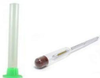
*Figura 17.* Hidrómetro triple escala y probeta de plástico
