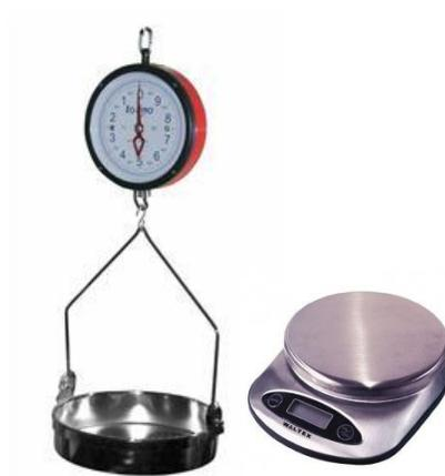
Figura 37. Básculas con capacidad para 10 y 2 Kg
