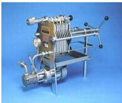
*Figura 29.* Filtro por prensa de placas de acero inoxidable
