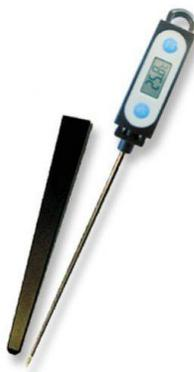
*Figura 16.* Termómetro digital con sonda en acero inoxidable
