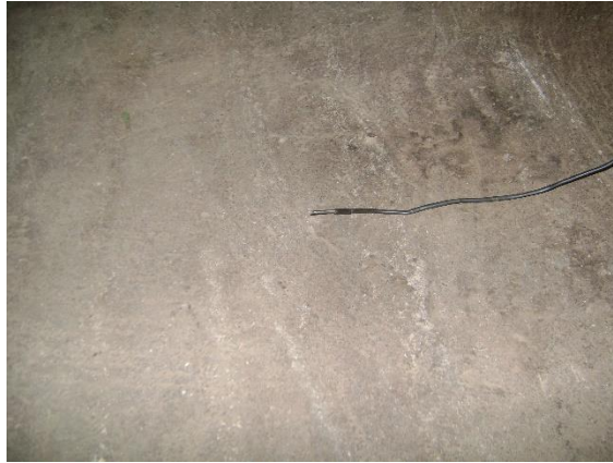
Anexo 5. Sonda térmica para el control de la temperatura interna de la cámara de tratamiento térmico. Plantel de la empresa Industrias La Chota Ltda. Santa Rosa de Pocosol, San Carlos de Alajuela. 2015.
