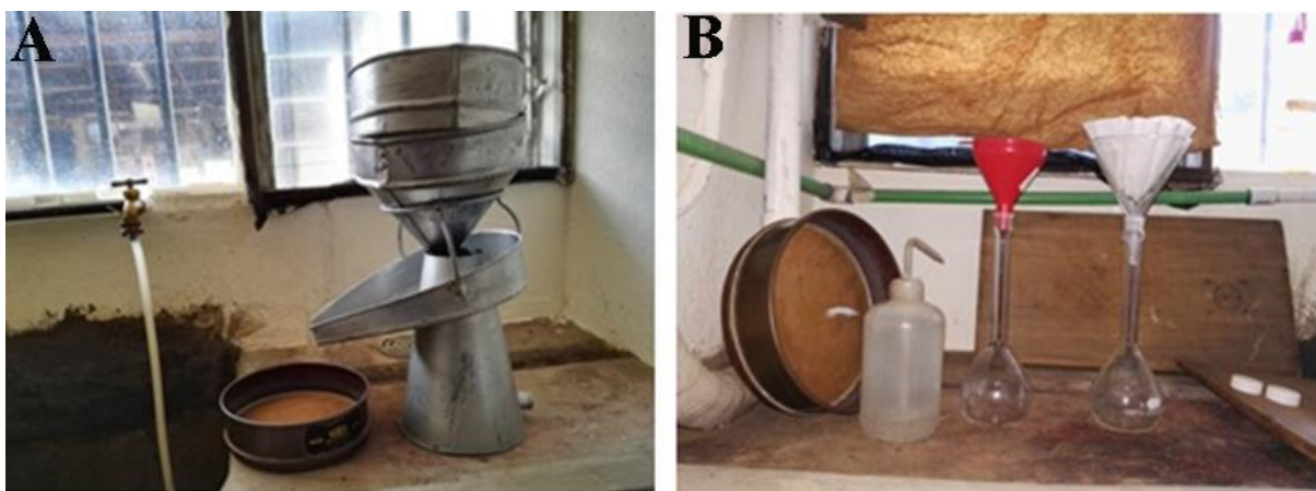
Figura 3. Fenwick (A), balones aforados, tamiz, pizeta y papel filtro (B). San José, Costa Rica. 2016.
