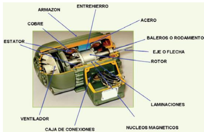
Figura 7. Partes del motor eléctrico.
