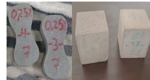
Figura 17. Briquetas (izquierda) y cubos (derecha) de mortero hidráulico fabricados según los requerimientos de las normas ASTM C307 y ASTM C109 respectivamente.
