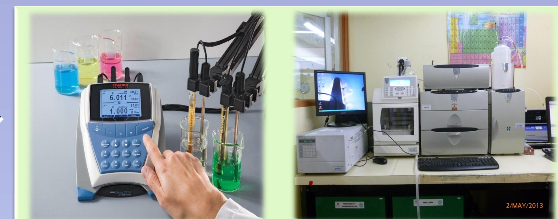
Figura 2. Comparación de métodos: Cromatografía de Iones (CI) y Electrodo de Ión Selectivos (ESI)
