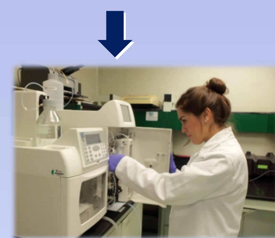
Figura 3. Análisis de flúor e iones de origen magmático mediante CI.
