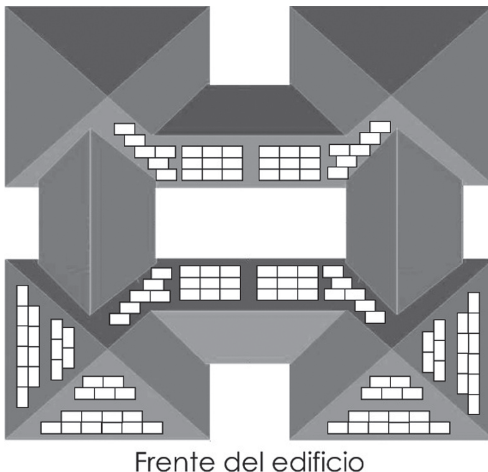
Figura 85. Vista superior de la disposición de 120 paneles fotovoltaicos sobre los sectores óptimos para el aprovechamiento del recurso solar disponible en el sitio.
