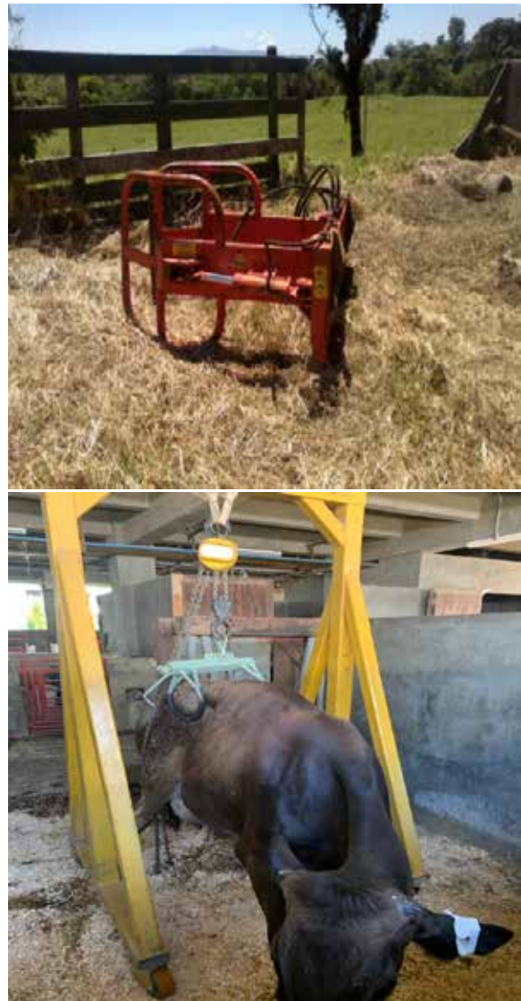
Fig. 86a - Dos modelos de "Prensa de Caderas" para bovinos, de gran utilidad para levantar y sujetar animales caídos
