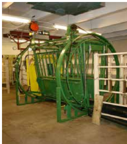
Fig. 88 - Prensa con extremos circulares que se utiliza en la Universidad de Colorado, Fort Collins, USA. En esta prensa se inmoviliza el bovino que entra a la misma por una manga y posteriormente se hace girar hasta alcanzar el ángulo deseado
