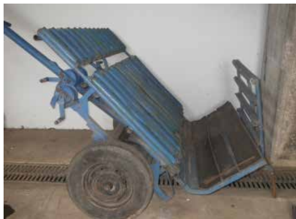
Fig. 87 - Mesa de volteo manual y portátil para bovinos (Escuela de Medicina Veterinaria, UNA, Costa Rica)
