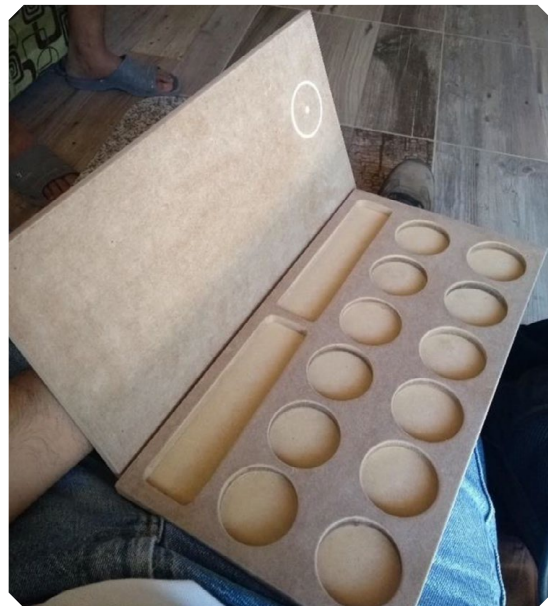
Figura 1. Prototipo de tablero diseñado y perfilado en madera comprimida. Los autores.
