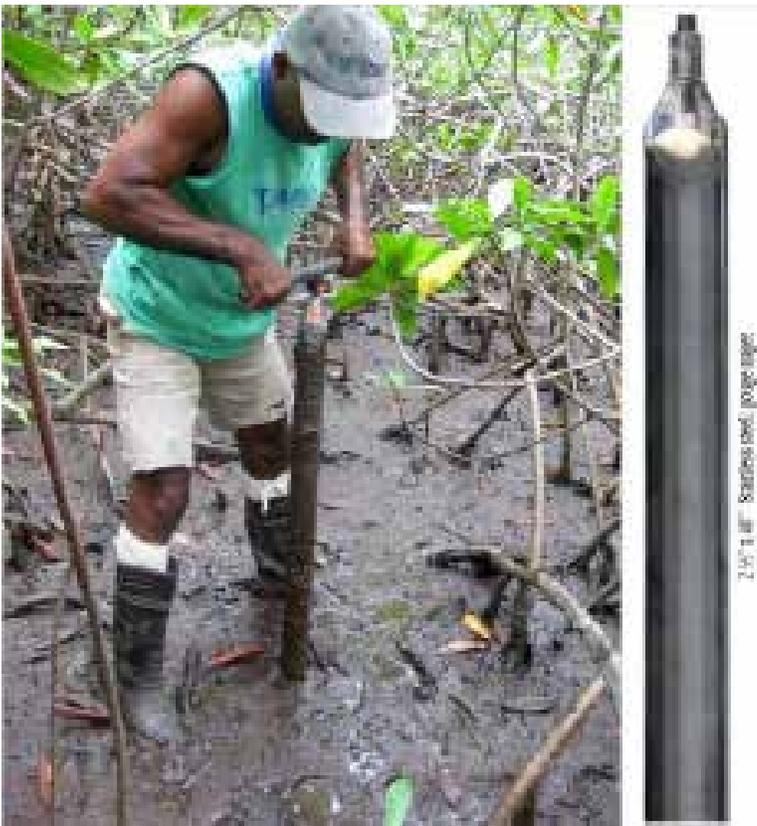
*Figura 7. Instrumento y técnica utilizada para el muestreo de suelo en manglares. (Fuente: Cifuentes et al. 2018)*
