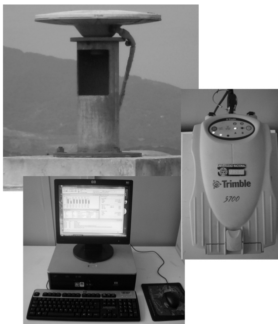
Figura 1. Antena geodésica, receptor 5700 y computadora disponibles en el SDG
