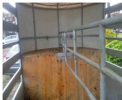
Fig. 62 - Carreta especialmente diseñada para transporte adecuado de animales grandes como equinos, donde se pueden ver los estándares mínimos de seguridad, ventilación, iluminación y comodidad mencionados antes
