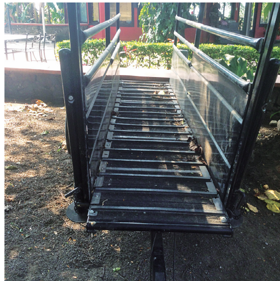
Fig. 63a - El cargadero usado en la foto de la izquierda es todo lo contrario a los estándares mínimos de seguridad recomendados internacionalmente. A la derecha se observa un mejor diseño para cargadero portátil.
