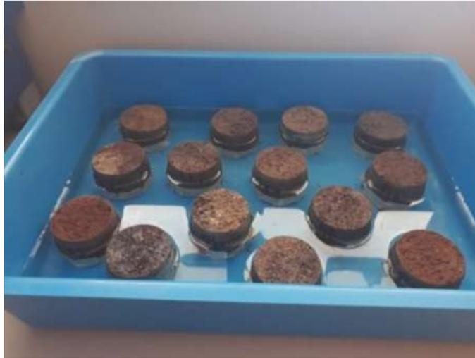
Figura 6: Muestras del P2 en proceso de saturación
