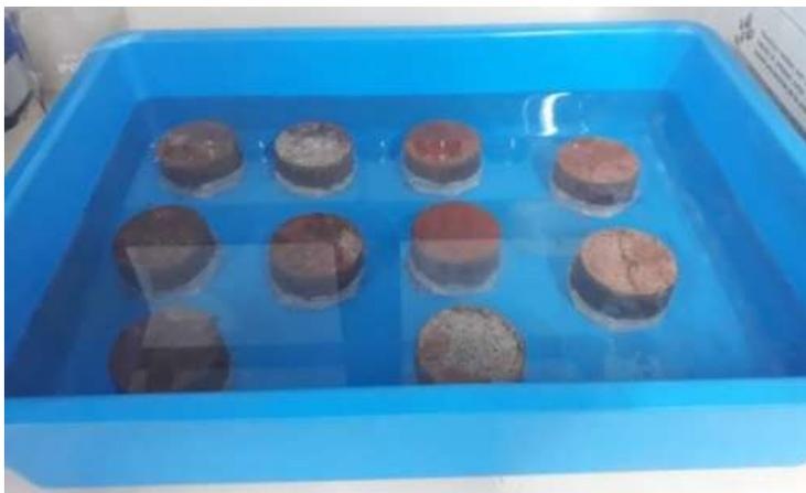
Figura 4: Muestras del P1 en proceso de saturación
