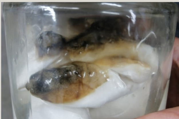
[4.2.13] Molde enfrascado por 3 meses Se formo una capa de hongos y descomposición del látex.
