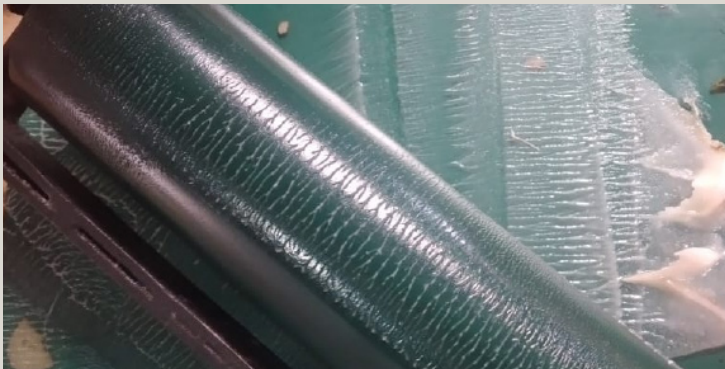
[5.5.1] Rodillo suave o semiduro Es utilizado para entintar con barniz blando, tinta y manteca la superficie deseada.
