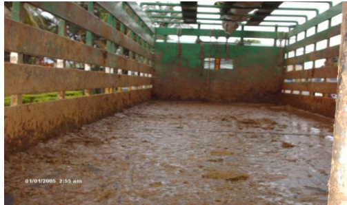
Fotografía 3. Camión sin ningún tipo de cama ni material antideslizante.
