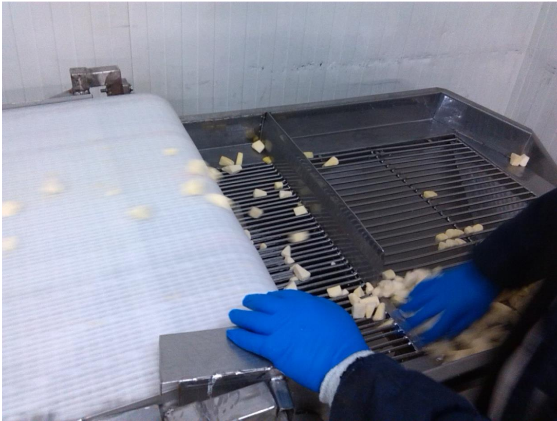
Figura 12. Proceso de selección de chunks empleado para separar el producto que cumple con las especificaciones óptimas.
