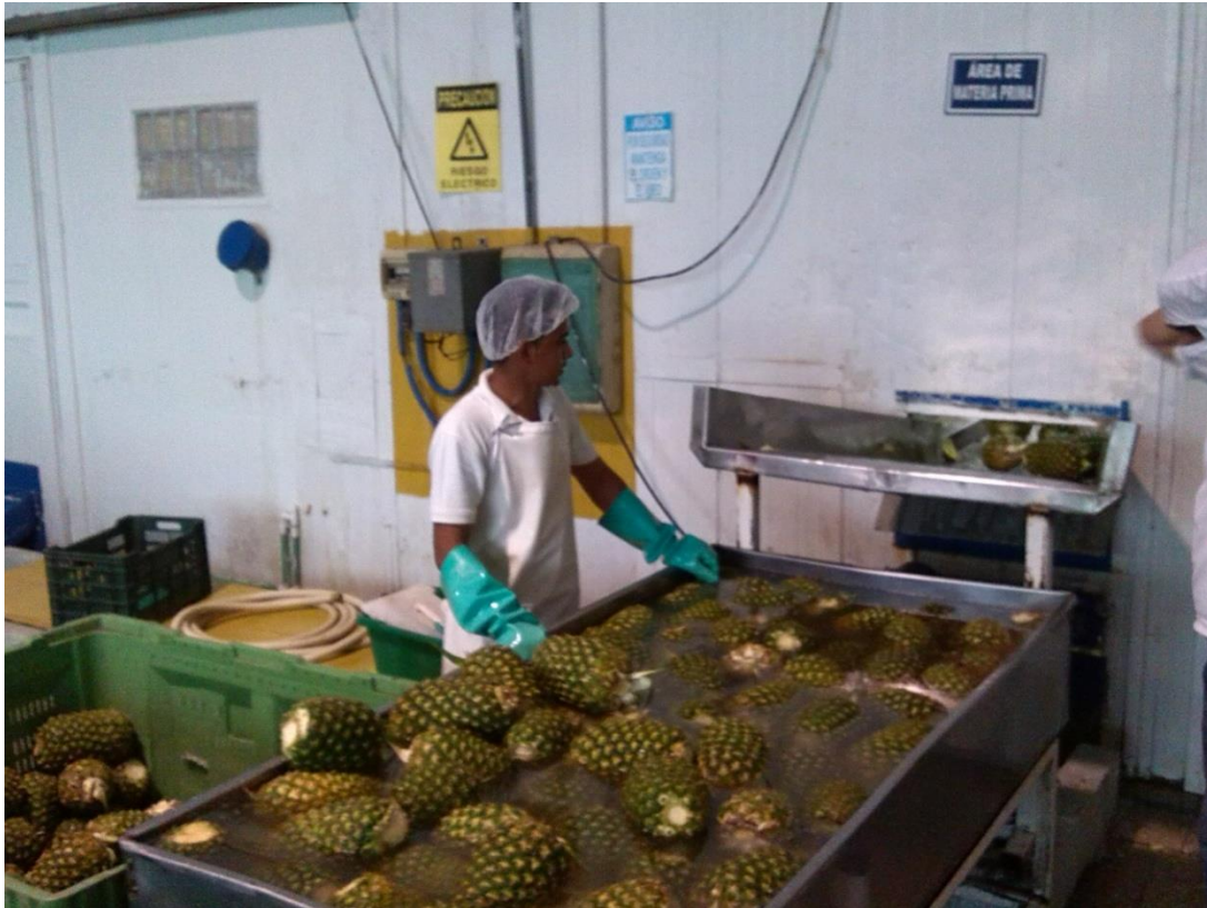
Figura 8. Método utilizado para el lavado de la piña antes de que entre a la línea productiva.
