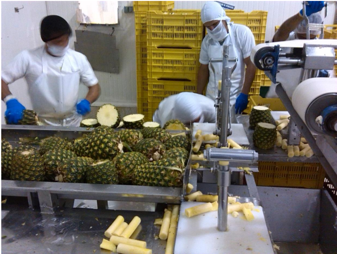
Figura 9. Equipo utilizado para la extracción de los corazones de la piña.
