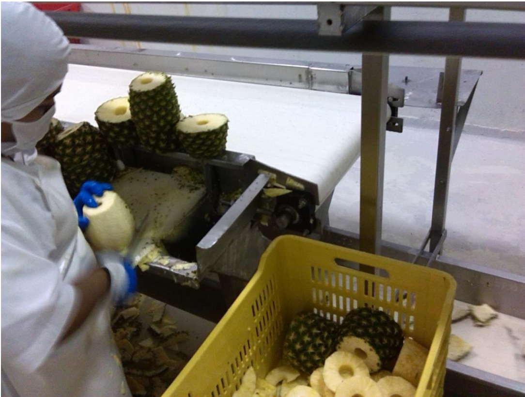
Figura 10. Técnica utilizada para el pelado de las piñas, el producto que sigue se coloca sobre la faja transportadora y el que no, dentro de la caja amarilla.
