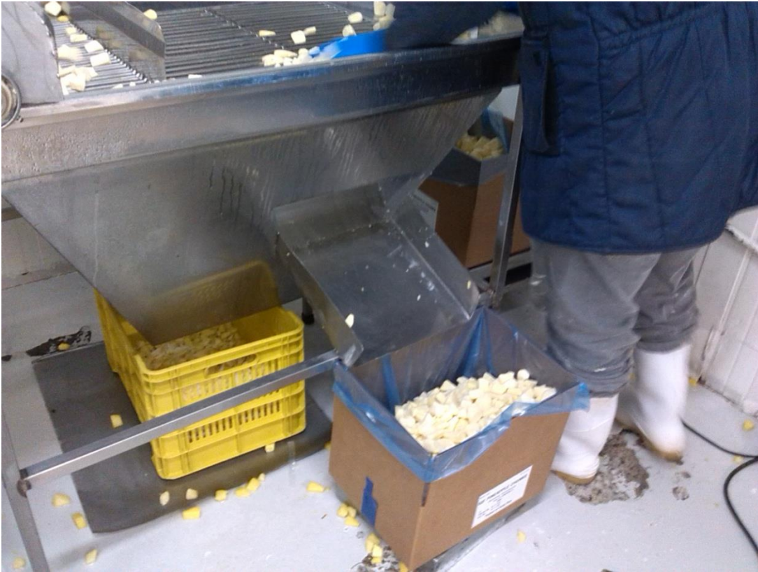
Figura 18. Derrames de materia prima generados en la etapa de selección y empaque.
