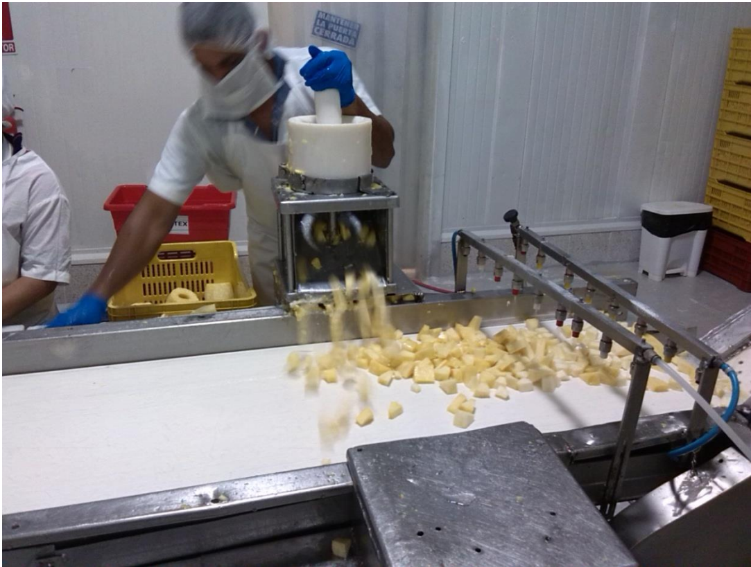
Figura 11. Troquelador utilizado para el corte en chunks de la piña.
