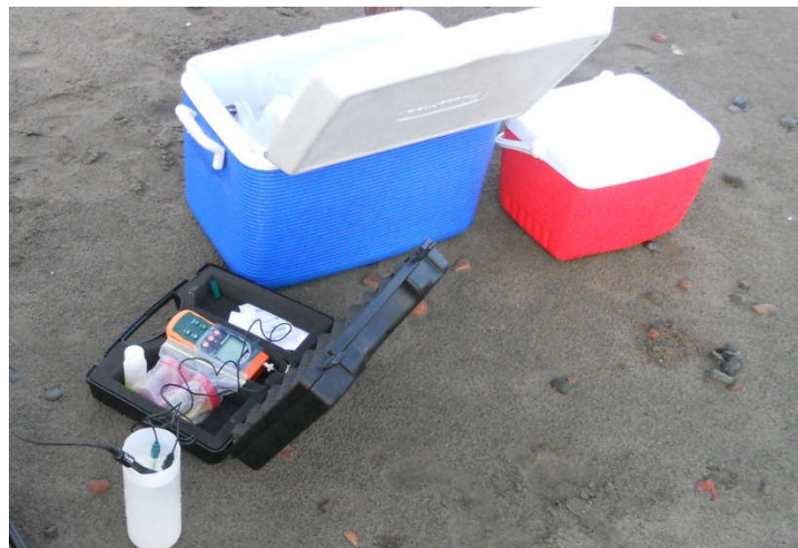
Figura 8. Medición In situ de la temperatura y el oxígeno disuelto. Playa Jacó, 2014
