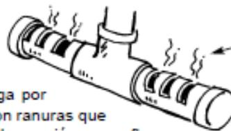
tubería con ranuras para distribuir a la entrada y recoger a la salida uniformemente las aguas
