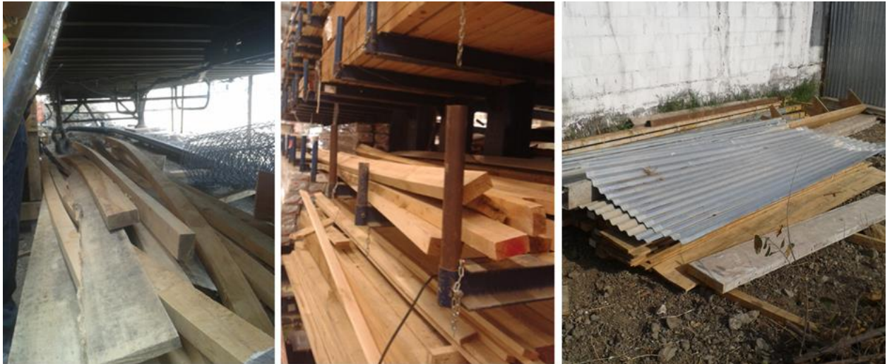
Figura 24. Almacenamiento inadecuado de la madera de algunos clientes del Grupo Empresarial El Almendro. Fotos tomadas en Alajuela, 2015
