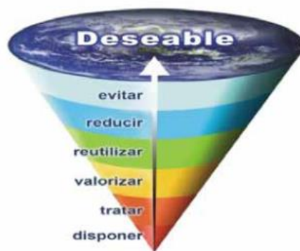
Figura 2. Jerarquía en el manejo de residuos Fuente: Centro Nacional de la Producción más limpia, 2007
