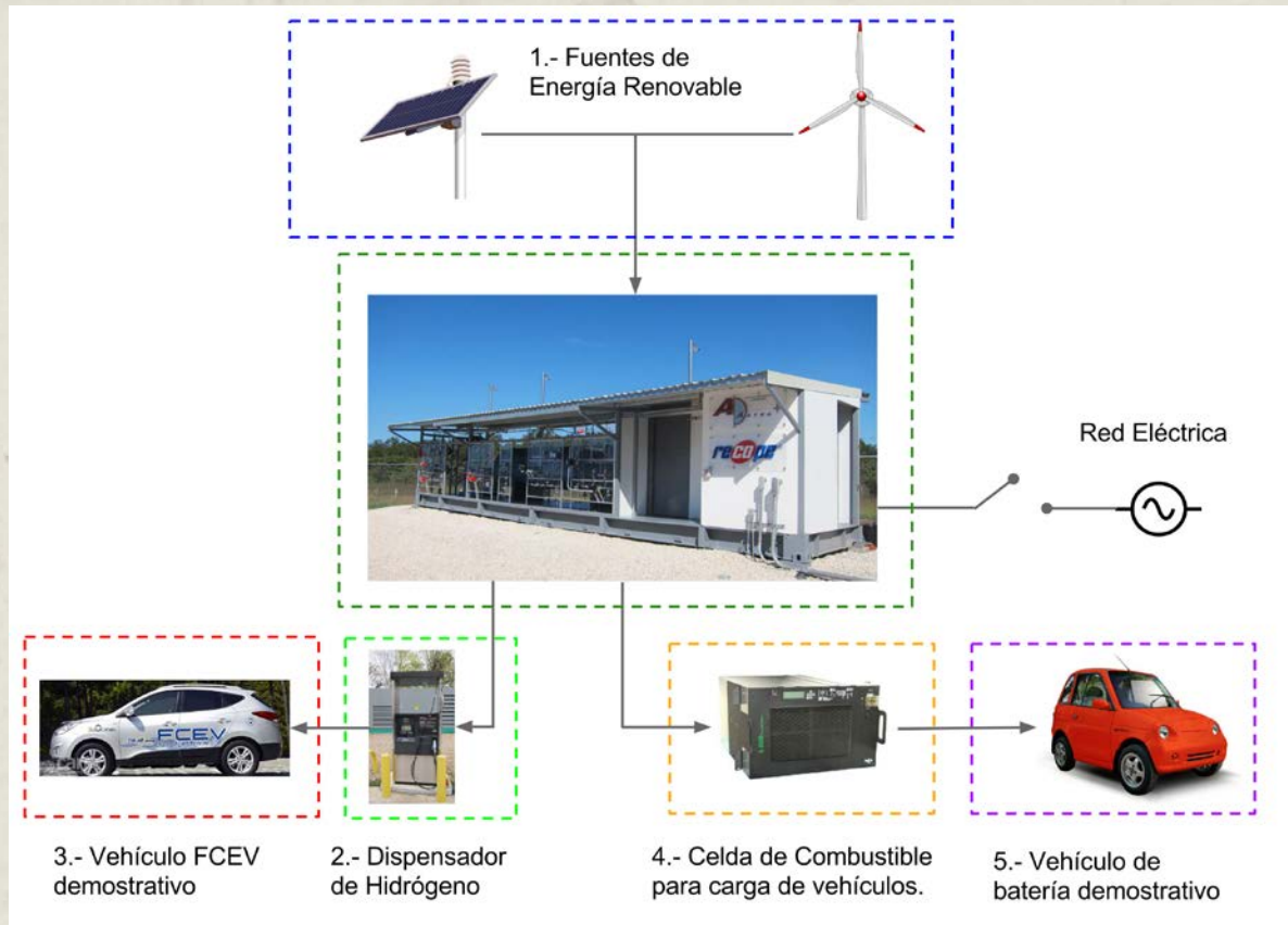
Figura 4. Diagrama de la arquitectura propuesta para la ampliación de la planta experimental durante la Fase C2 de la investigación conjunta entre Recope y Ad Astra Rocket.
