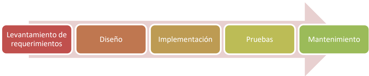
Ilustración 9 Diagrama de etapas de un ciclo de vida de cascada (Velázquez, s.f.).
