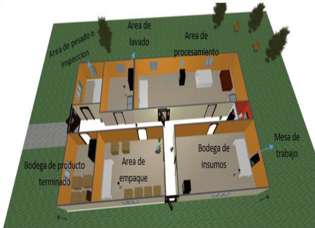
Figura 50. Diseño y distribución de la planta industrializadora de frijol. Elaboración propia con base a floorplanner 3D.
