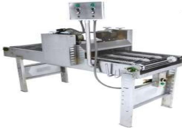
*Figura 58.* Máquina desoperculadora. Catálogo X-nox 2016.
