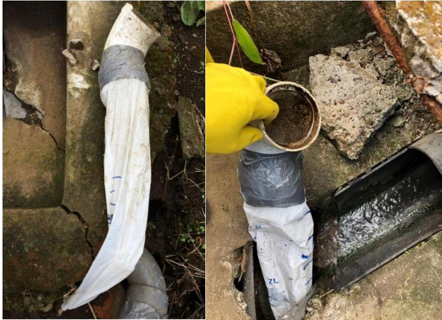
*Figura 8.* Bolsa de polietileno empleada para la medición de caudales.
