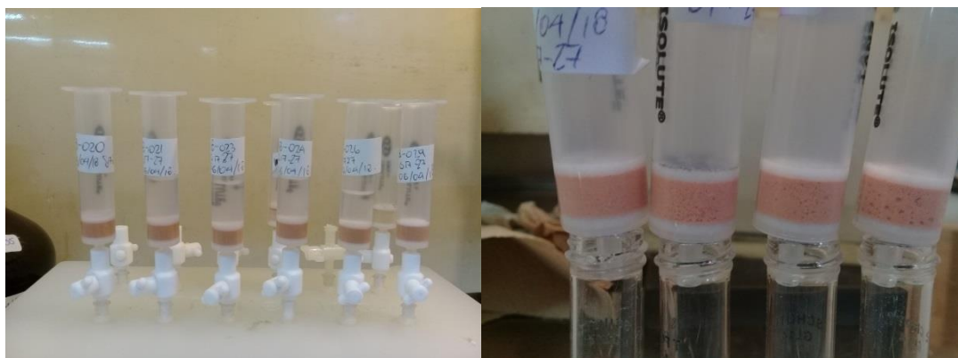
Figura 14. Proceso de extracción con fase sólida de las muestras.
