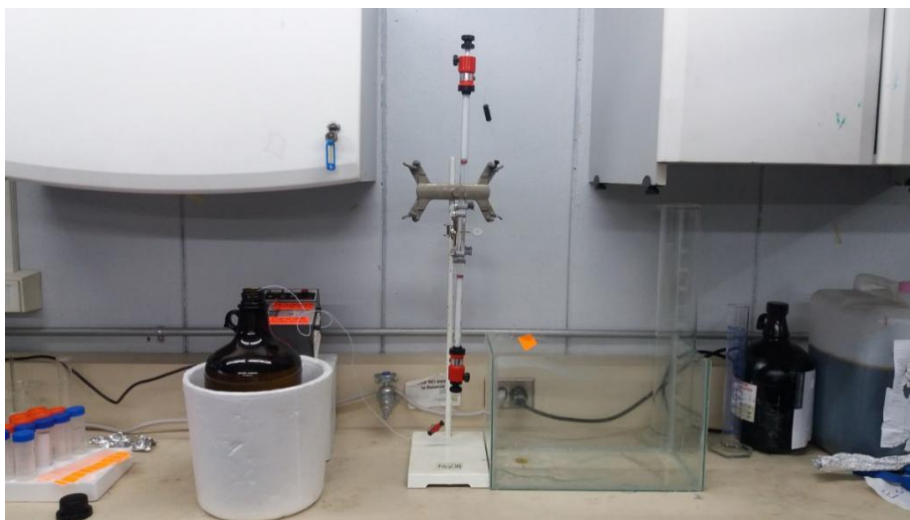
Figura 11. Sistema de remoción de flujo constante con CA-1.
