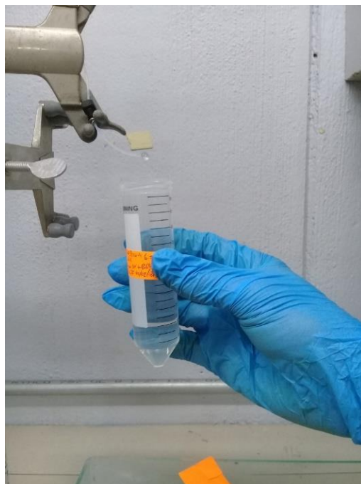
Figura 13. Toma de una muestra a la salida de la columna.
