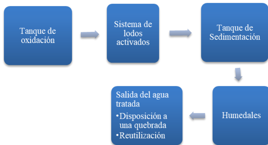
Figura 49. Diagrama de flujo de las etapas de la planta de tratamiento de aguas residuales del Relleno Sanitario Tecnoambiente.
