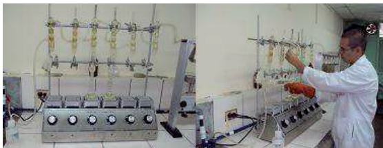
Figura 4. Análisis de lípidos usando un extractor Soxhlet
