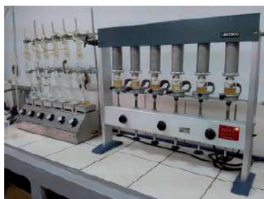
Figura 47. Equipo de extracción Soxhlet para análisis de lípidos
