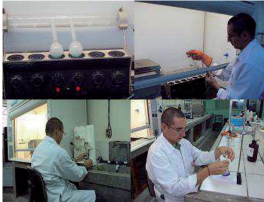
Figura 3. Análisis de proteína por método Kjendhal
