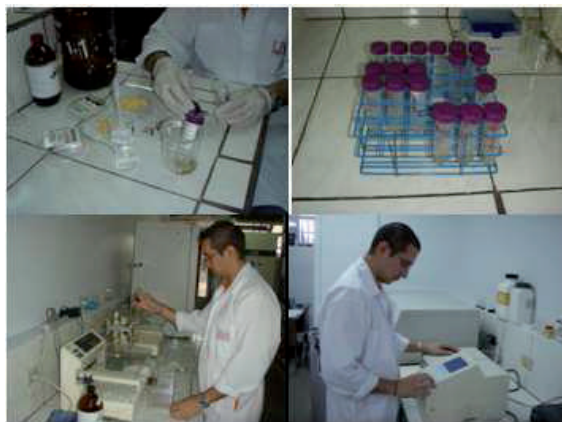
Figura 8. Análisis de Valor K por método de cromatografía de intercambio iónico
