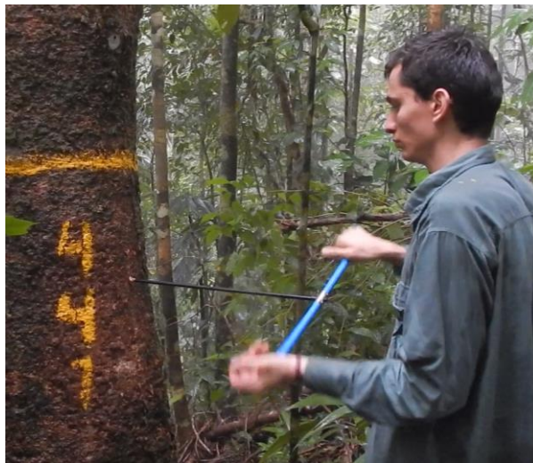
Figura 4. Muestreo del peso específico de la madera 20 cm debajo del DAP (línea amarilla).
