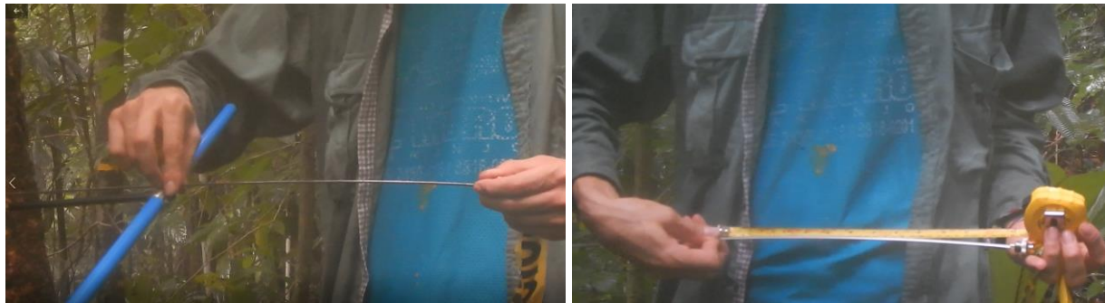
Figura 6. Uso del extractor para determinar cuánto se ha introducido el barreno en el árbol en el muestreo del peso específico.
