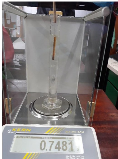
Figura 7. Método de desplazamiento del agua para medir el volumen de muestras de madera. La lectura de la balanza digital es igual al volumen de la muestra (con la equivalencia de 1\text{ g} = 1\text{ cm}^3 ).
