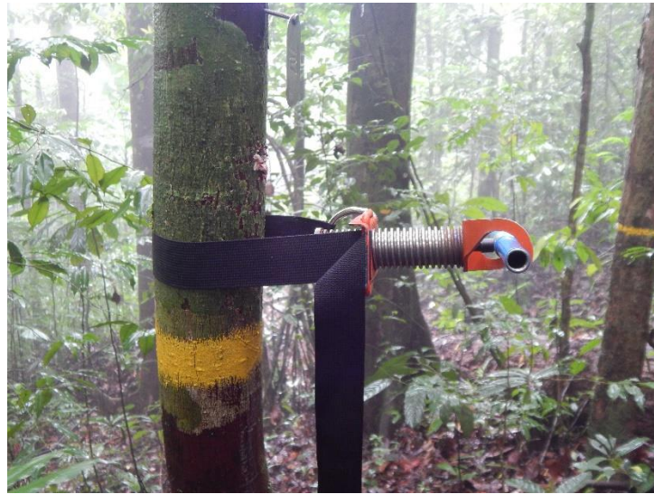
Figura 5. Muestreo de peso específico de madera facilitado con un “iniciador o linga”.
