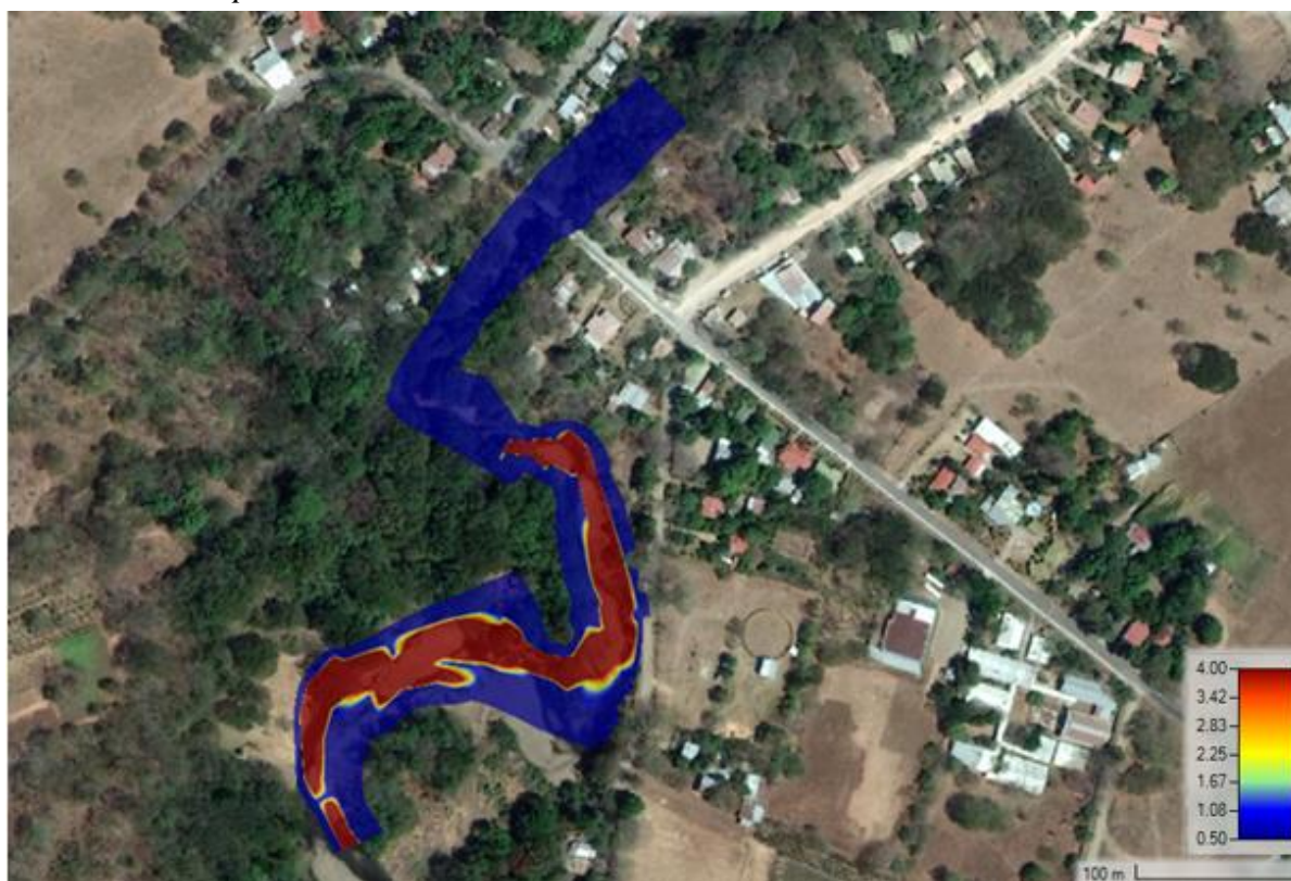
Imagen 27: Velocidades reportadas mediante la simulación hidráulica en el tramo en estudio del río Santa Bárbara.
