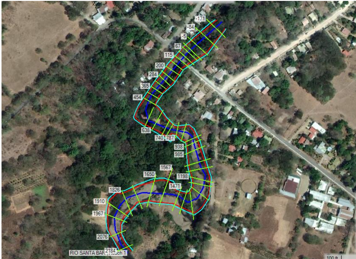
Imagen 28. Ubicación de las secciones transversales trazadas en el cauce del río Santa Bárbara.
