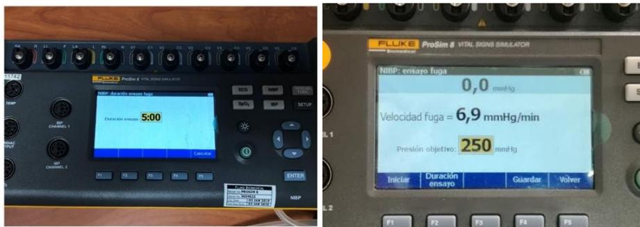
Figura 4. Prueba de fuga de aire.
