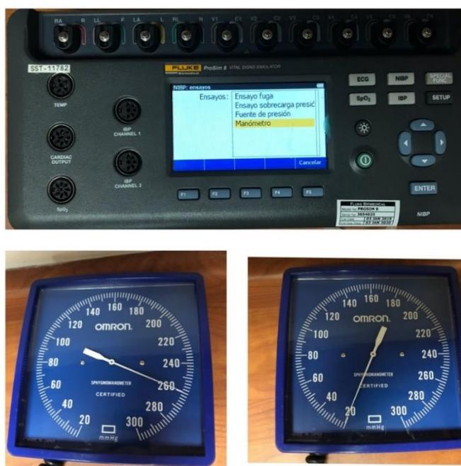
Figura 5. Prueba de escape rápido.
