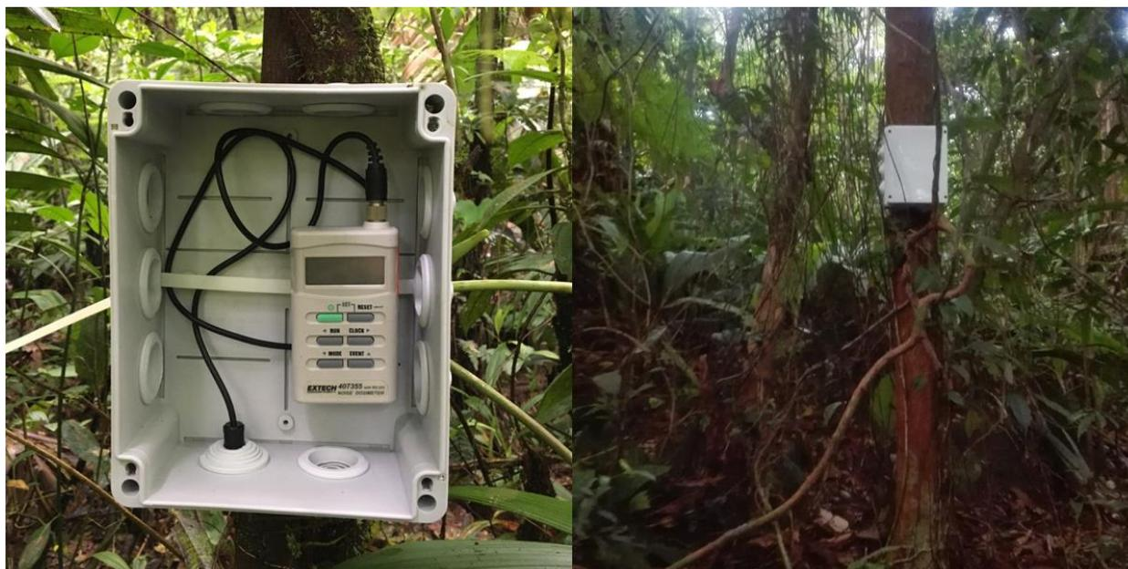
**Figura 2.** Equipos de monitoreo de ruido ambiental instalados en el sitio Quebrada González.
