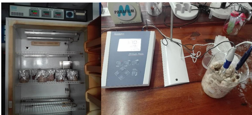
Figura 4. Las fermentaciones aeróbicas en beakers dentro de la incubadora (derecha) y toma de pH de la pulpa (izquierda).
