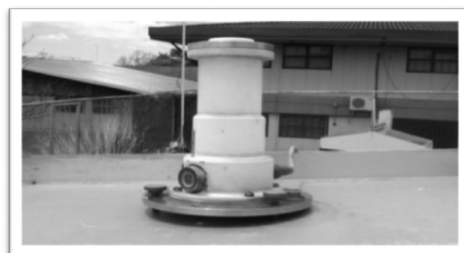
Figura 2. Radiómetro RUV (UV-A+UV-B) utilizado en la medición de la radiación ultravioleta en la banda espectral 280-385 nm.
