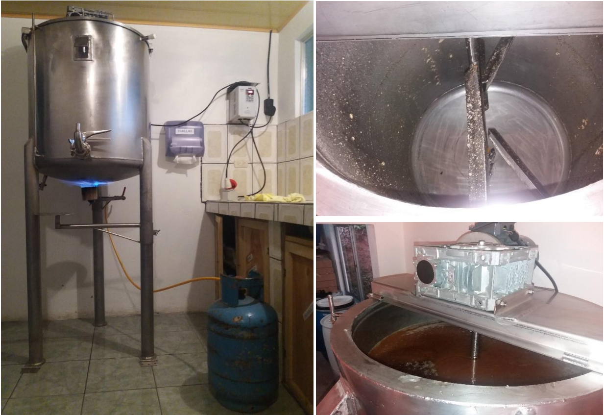
FIGURA 8. Equipo industrial “Marmita” para descrystalizar miel. Fuente: Elaboración propia 2021.
