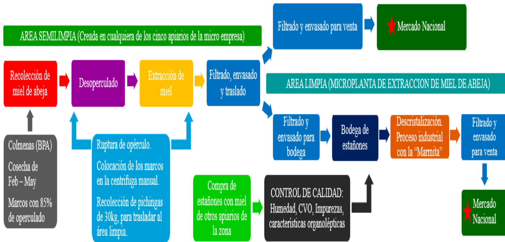
FIGURA 3. Esquema de los procedimientos técnicos-industriales de la miel de abeja en la microplanta familiar Zamora Fernández.
