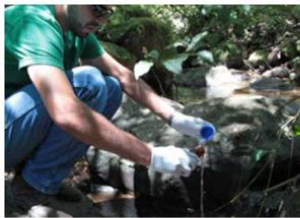
Figura 2. Toma de muestra de agua para análisis microbiológicos
